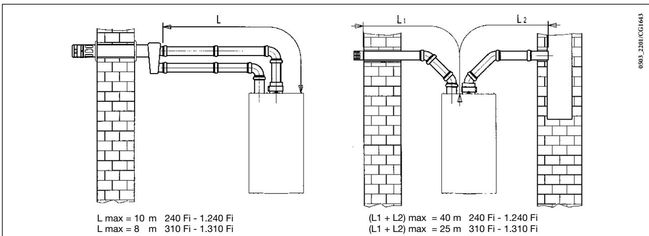
**ПРИМЕЧАНИЕ:** При использовании терминалов марки С52, устья воздуховодов притока воздуха и удаления продуктов сгорания ни в коем случае не должны располагаться по разные стороны здания.
