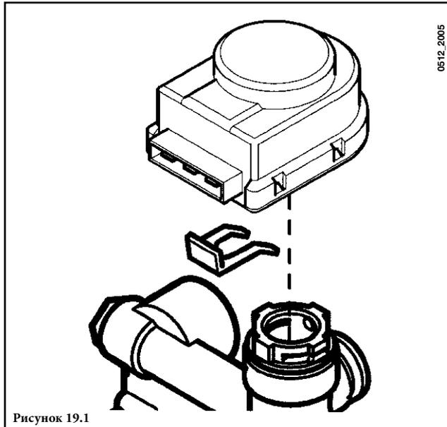
**Примечание:** перед установкой привода для трехходового клапана снимите колпачок с этого клапана.
