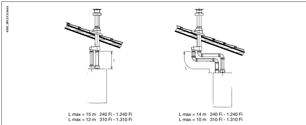
**ВНИМАНИЕ:** если устанавливается индивидуальная дымовая труба, убедитесь, что выполнена достаточная изоляция (например, с помощью стекловолокна) в местах, где труба проходит сквозь стены здания.
